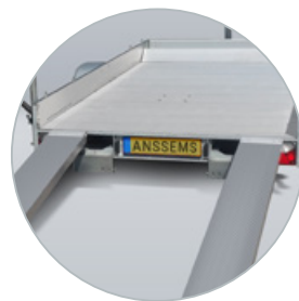
Aluminium rijplaten in geïntegreerde rijplaathouders
